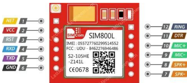
Рисунок 3.3 – Пины модуля SIM800L
