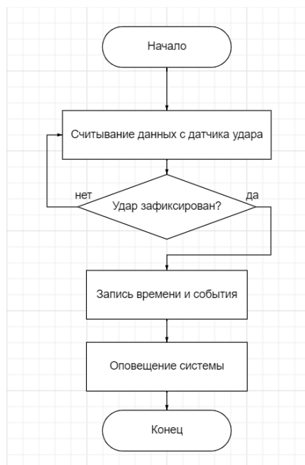
Рисунок 2.3 – Алгоритм работы датчика SW-420
